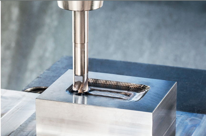
Flexibilität ist Trumpf: Beim Multi-Master-System von Iscar kann jeder Fräskopf auf unterschiedliche Schaftausführungen montiert werden. (© Iscar)
